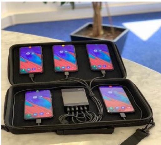
Kits de mesure comprenant des téléphones avec des cartes SIM de chaque opérateur pour mesurer en dynamique ou statique la couverture de téléphonie en voix, SMS et données. Les protocoles de mesure sont conformes à la réglementation de l'ARCEP.
